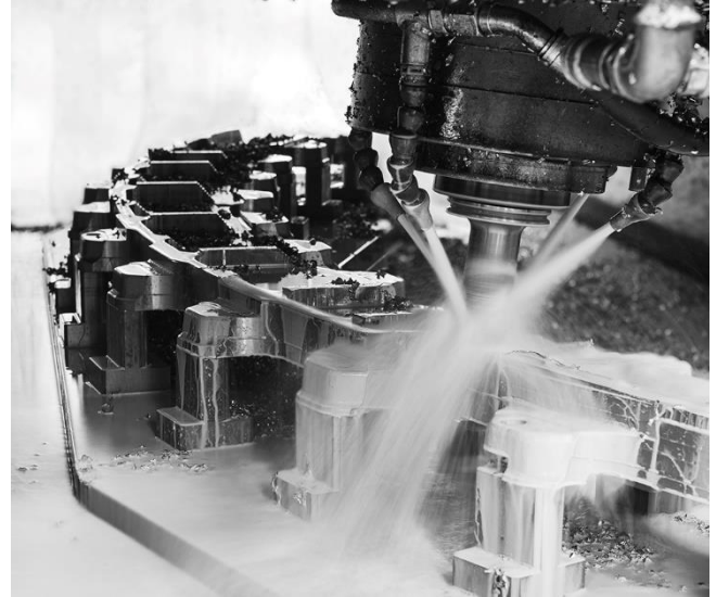
Usinage pièce titane sur le site d'Amboise
